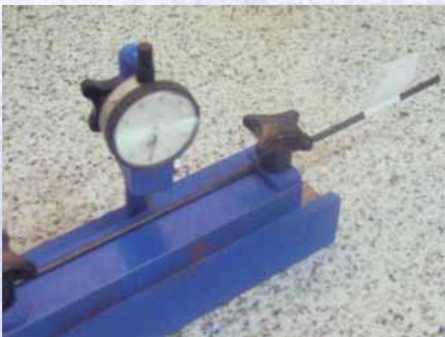
Control de la grafila del acero de pretensar.
