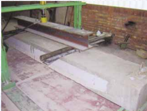
Ensayo a cortante. Forjado de prelosa.
