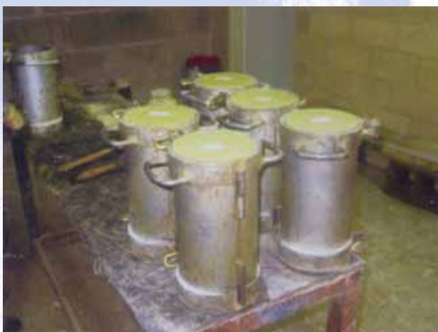
Probetas de hormigón.
